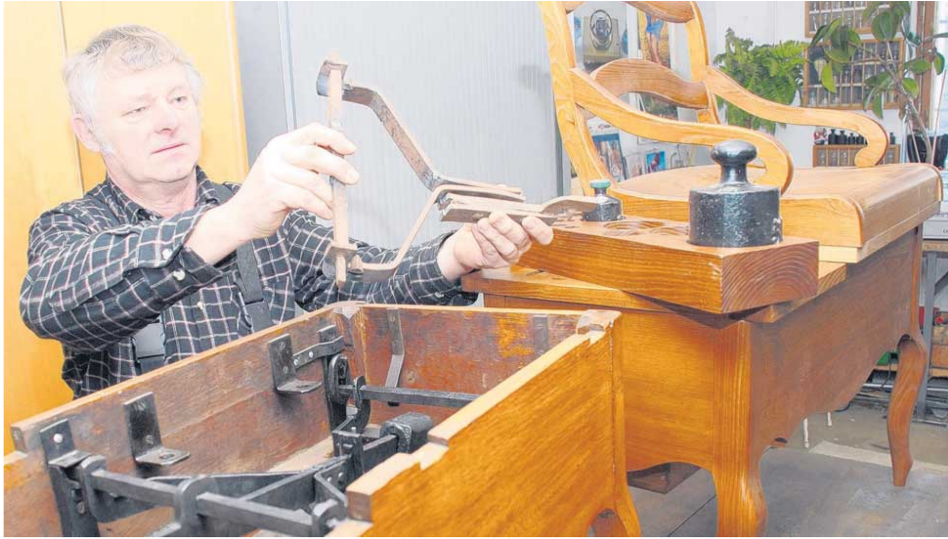
Links das Original, rechts der Nachbau: Der Oschatzer Waagenbauer Renold Krause hält einen sogenannten Runterzugebel in den Händen, den er in die neue Stuhlwaage einbauen wird. Mit dem Nachbau soll erstmals zum Ratsherrenwiegen im Dezember das Gewicht der Stadträte bestimmt werden. Foto: Dirk Hunger
